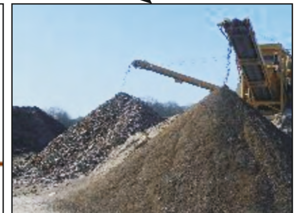
5/ Stockage sur l'aire de transit dans l'attente d'une campagne de concassage et criblage
