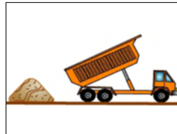
3/ Déchargement des matériaux en marche arrière sur la plate-forme de dépotage
